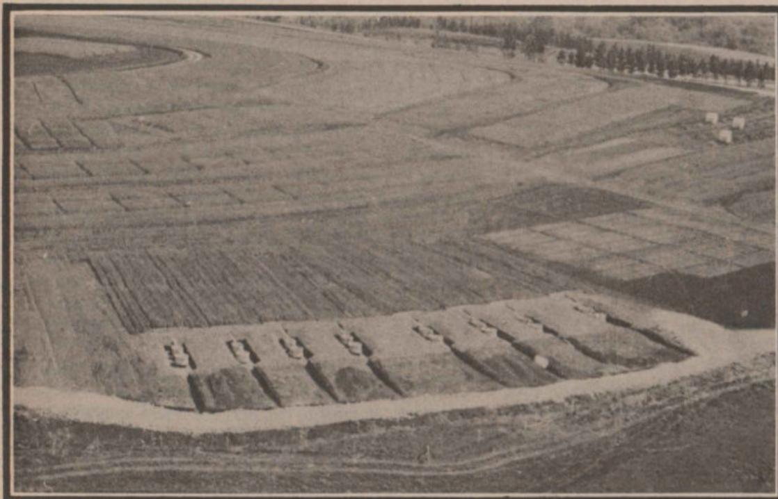
Equipamento para medição da perda de terra por efeito da erosão. Cada um dos oito aparelhos que aparecem na foto recebe resíduos de solo oriundo de um tipo de lavoura ou plantio, para que os técnicos possam optar pelo melhor em cada caso.
